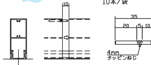
取付手順：ビスホールにジョイントピンをハンマー等でねじ部が完全に隠れるまで打ち込み、本体をずらして嵌合後、本体をスライドして相手側のビスホールへ差し込んでください。
