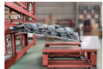
EVFN-1600 2010N/m 2 屋根面 試験の様子
