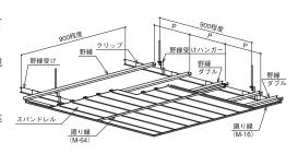
施工部位別の天井下地材の種類と下地間隔(公共建築工事標準仕様書(建築工事編)による)
