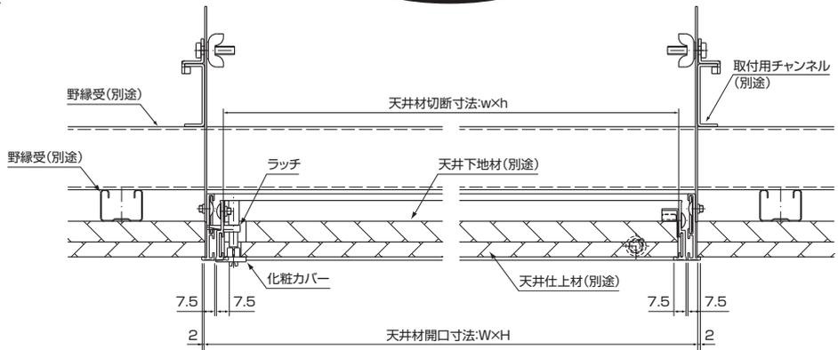
※適応天井上上材厚 3mm~12.5mm(上上材+下地材:3mm~26mm)
