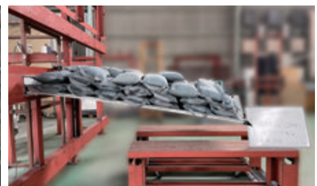
EVFN-1600 2010N/m 2 屋根面 試験の様子
